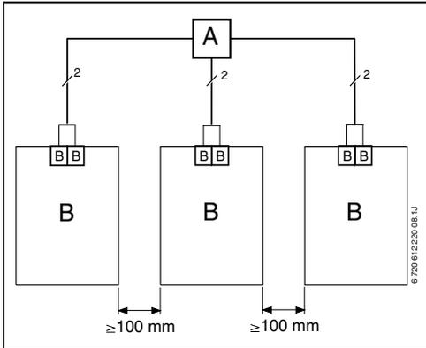
Bild 10 Anschluss der BUS-Verbindungen über Abzweigdose (A)
